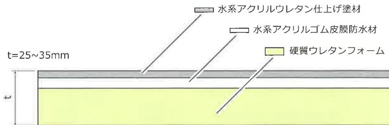
■「STテクニカル工法」に使用する特殊な硬質発泡ウレタンは、1㎡あたり約3kgと超軽量なため二重屋根工法等のように屋根に余計な重量負担を掛せずに施工可能です。
